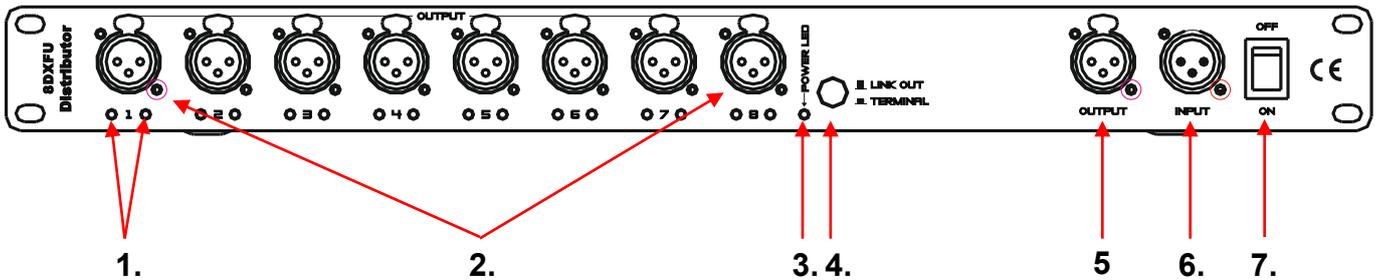
1. **Светодиодный индикатор:** Зеленый – выходной канал готов к эксплуатации, гаснущий красный указывает на неисправность (например, короткого замыкание)
