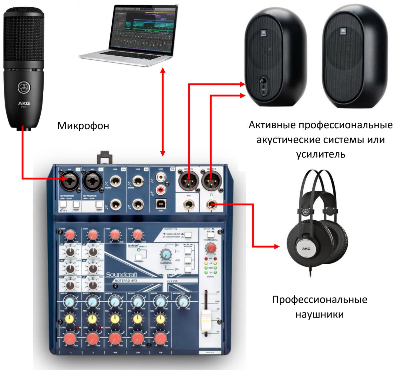
**Внимание!** Для подключения внешних устройств (микрофонов, гитар, акустических систем) вам понадобятся профессиональные аудио-кабели. Перед покупкой кабелей уточните типы разъемов на ваших устройствах. Это могут быть разъемы XLR, Mono ¼" Jack (небалансный), Stereo ¼" Jack (балансный) и другие.
