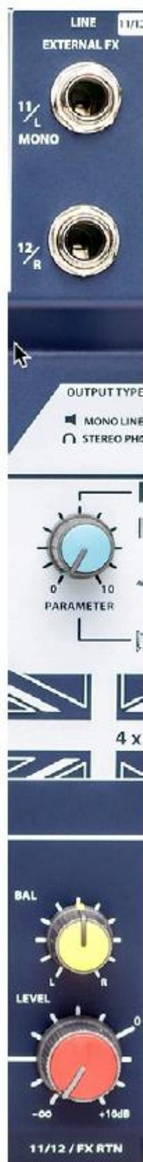
Из-за того, что регулятор посыл в шины AUX и FX является совмещенным, забор сигнала осуществляется до фейдера (pre-fade). Доля сигнала каждого канала в AUX/FX шине не зависит от положения основного регулятора уровня (Level) на входной линейке пульта.
