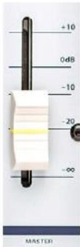
Мастер-фейдер определяет выходной уровень сигнала главной стерео-шины MASTER.
